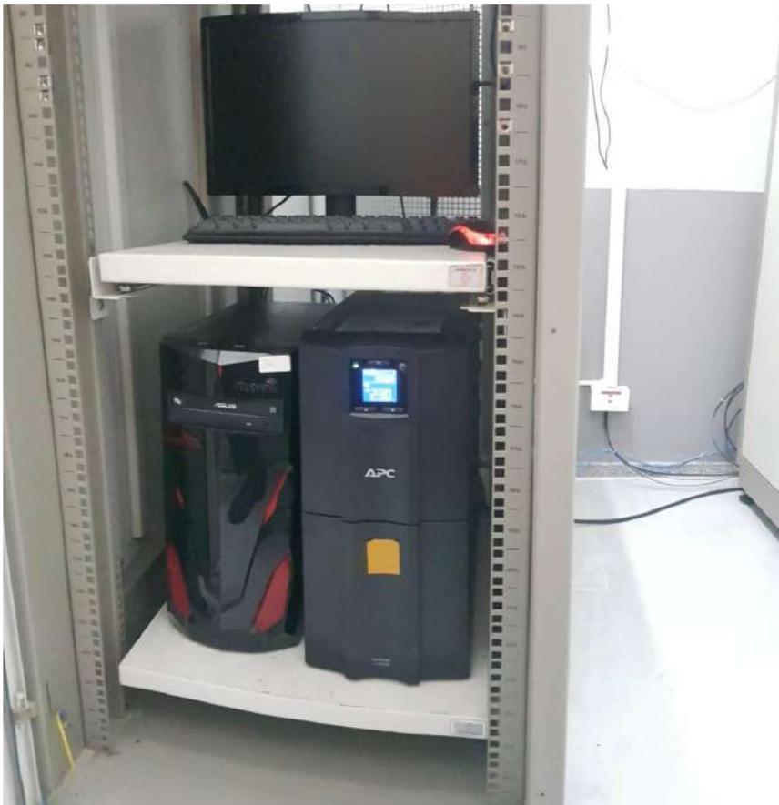
2. Server (ทั้ง Master และ Slave ) เป็นแบบ ระบบ RAID10 Hard Drive จำนวน 4 ลูก มาทำงานร่วมกันทั้งแบบ Stripe และ Mirror
